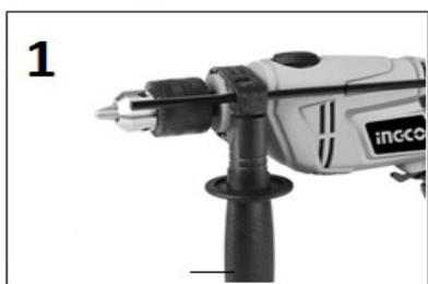
Для монтажа дополнительной рукоятки отверните нижнюю часть против часовой стрелки настолько, чтобы рукоятку можно было легко и свободно надеть через зажимной патрон на фланец. После этого установите рукоятку в удобное для работы положение и закрепите, поворачивая нижнюю часть по часовой стрелке.
