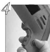
В зависимости от назначения вставьте необходимое сверло. При необходимости отрегулируйте глубину сверления.
