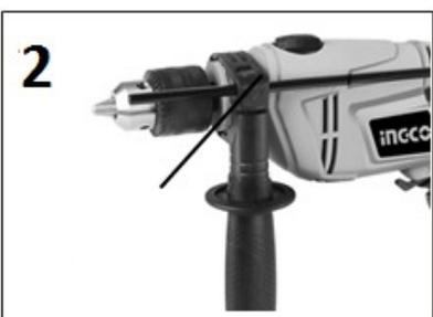
На дополнительной рукоятке находится приспособление для установки ограничителя глубины сверления. Вставьте сверло. Ослабьте зажимной винт на креплении дополнительной рукоятки. Выдвиньте ограничитель глубины сверления вперед настолько, чтобы его конец был на одном уровне со сверлом. Теперь отодвиньте ограничитель глубины сверления назад настолько, чтобы расстояние между его концом и концом сверла соответствовало требуемой глубине сверления. Затяните зажимной винт, вращая его по часовой стрелке.
