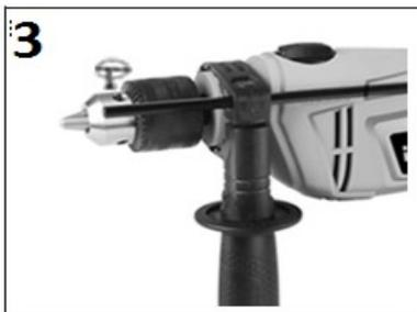
Установка или извлечение сменного инструмента осуществляется при помощи специального ключа. Установите ключ патрона в одно из отверстий в патроне. При вращении ключа по часовой стрелке губки патрона сходятся, фиксируя, тем самым, хвостовик сменного инструмента. При вращении ключа против часовой стрелки губки патрона расходятся и освобождают инструмент.
